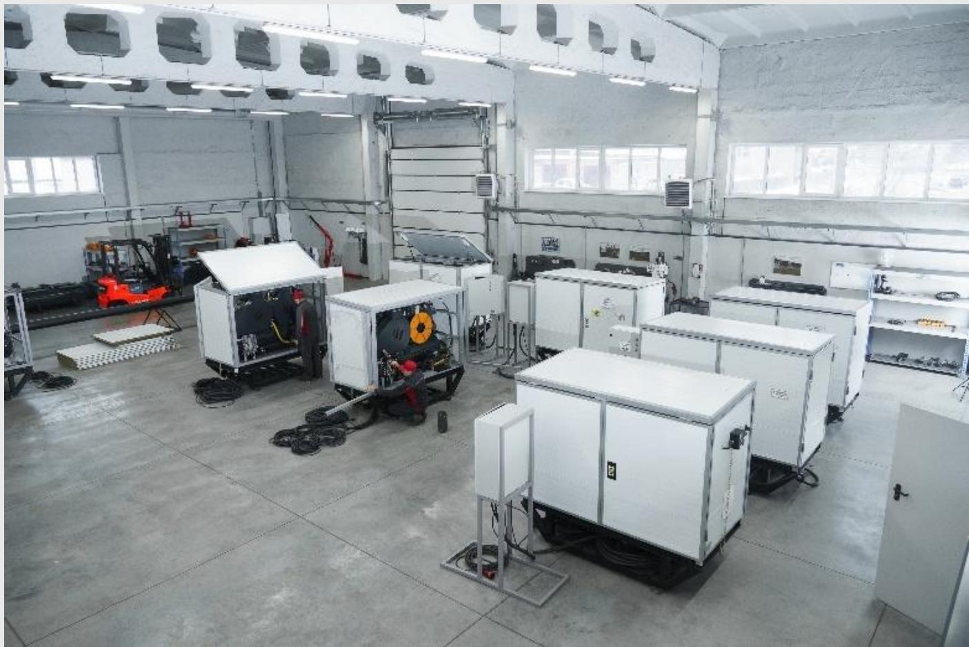
Компания ООО «ЗАМАН» является экспертом в производстве мобильных скважинных компрессорных установок (МСКУ) – эффективного решения для устранения повышенного содержания газа в затрубном пространстве нефтяных скважин при добыче пластовой жидкости.
