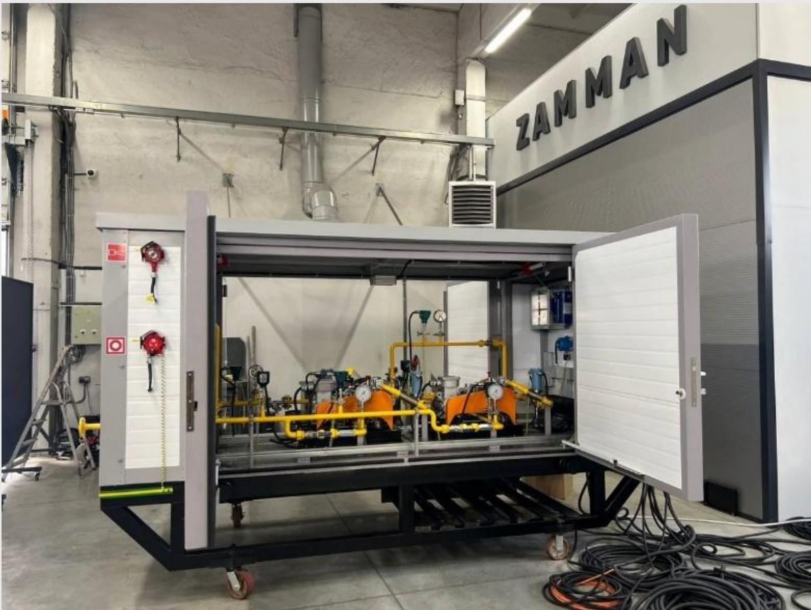
Компрессорные станции (КС) производства ООО «ЗАМАН» предназначены для перекачки природного газа из магистрального газопровода, его компримирования и подачи к Потребителю.
